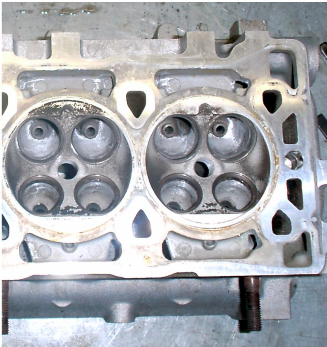
la testata usata per il motore a fasatura variabile ha le valvole più grandi degli altri modelli, aspirazione di 31.5 e scarico 27.3
