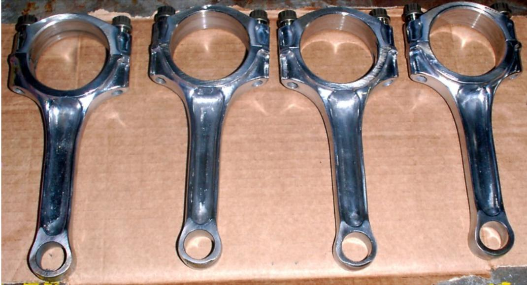
è stato necessario fare un foro per la lubrificazione, perchè verranno montate coi pistoni a spinotto flottante
